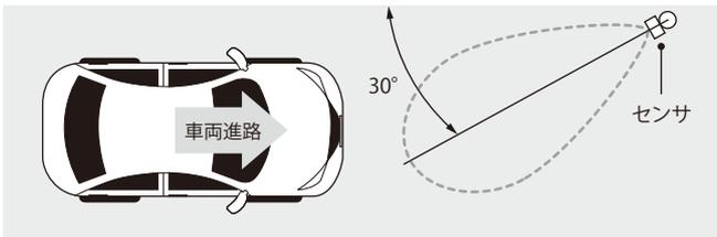
※2車線幅の道路にてご使用の際は、兄弟機種のOVS-01GTP(J)を2台使用するシステムが適切です。
